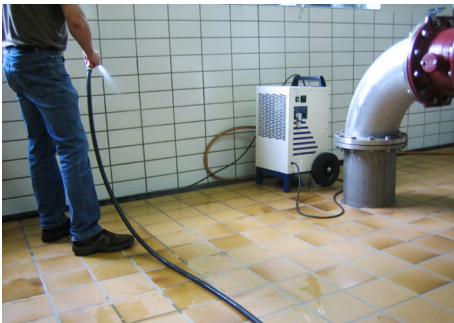
Abb. 11 Strahlwassereinwirkung auf Anschlussleitung und Betriebsmittel
